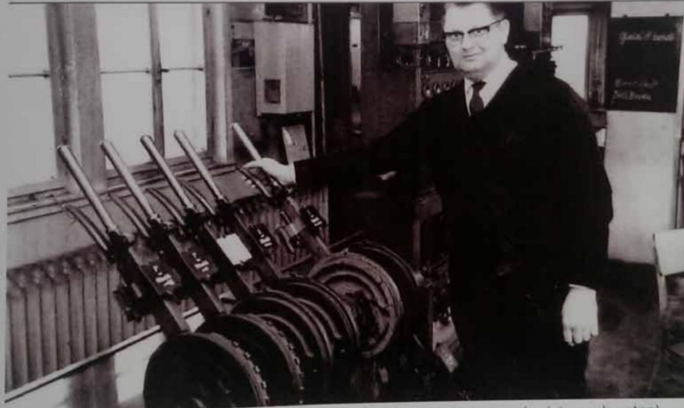
Hier die sechs Signalhebel (der zweite Hebel von rechts war umgelegt und zeigte nach unten). Außerdem waren noch elf Weichen zu bedienen. Durch das Blockwerk (von blockieren), das hinter zu sehen ist, wurde die Sicherheit im Eisenbahnbetrieb hergestellt.
